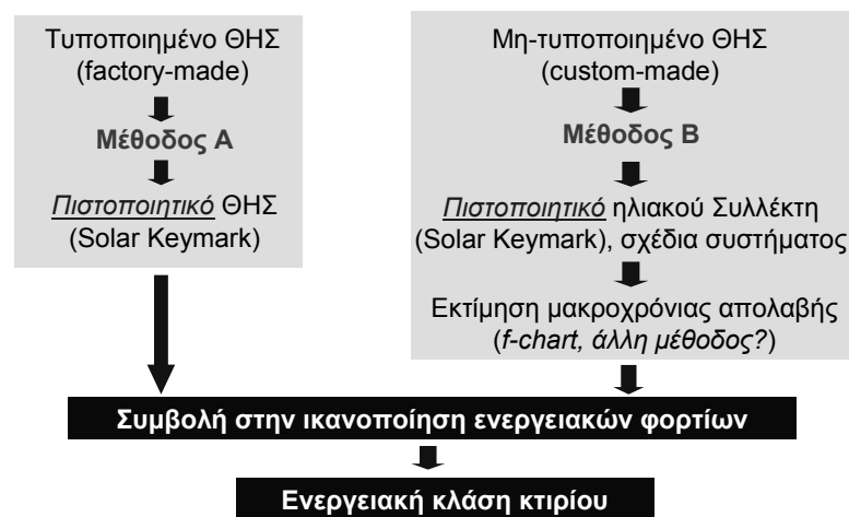
Σχήμα 6. Διαδικασία υπολογισμού της συμβολής ενός θερμικού ηλιακού συστήματος στο ενεργειακό ισοζύγιο ενός κτιρίου σύμφωνα με το Πρότυπο EN 15316-4-3.
