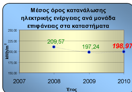
Διάγραμμα 2. Μέσος όρος της κατανάλωσης ηλεκτρικής ενέργειας ανά m^2 σε καταστήματα της Τράπεζας το διάστημα 2008-2010
