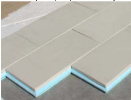
Εικόνα 1. Αρχική κατάσταση εξηλασμένου πολυστυρενίου με επίστρωση τσιμεντοκονίας
