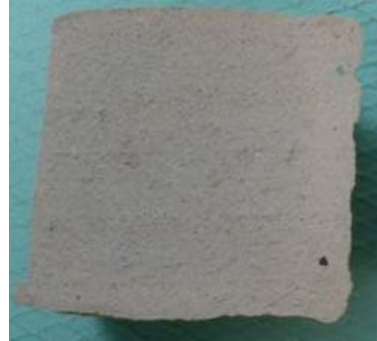
Εικόνα 10. Σημείο θραύσης δοκιμής επί πλανισμένης διαμόρφωσης, θραύση μεταξύ κόλλας και XPS
